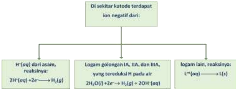
Gambar 3.4 jenis reaksi yang terjadi di Katoda dengan berbagai jenis elektroda
