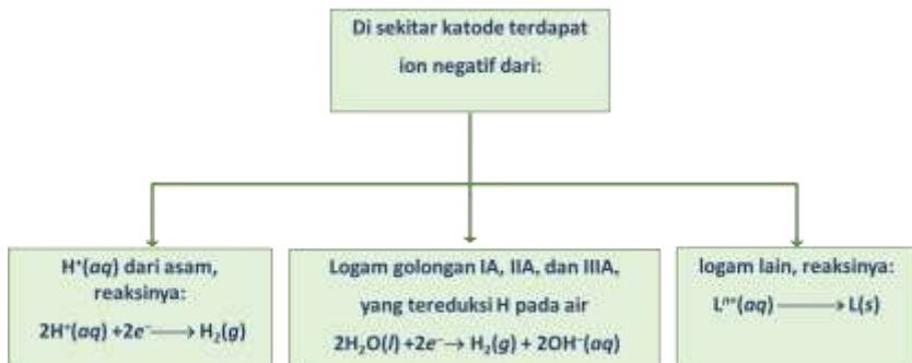
Gambar 3.4 jenis reaksi yang terjadi di Katoda dengan berbagai jenis elektroda
