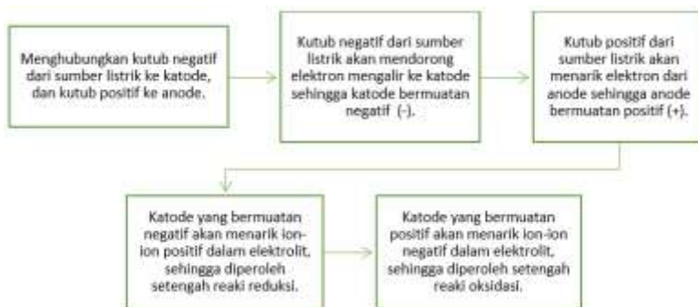
Gambar 3.2 diagram arus listrik dan kutub pada proses elektrolisis
