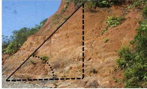
Gambar 65. Contoh Pengukuran Sudut Vertikal
